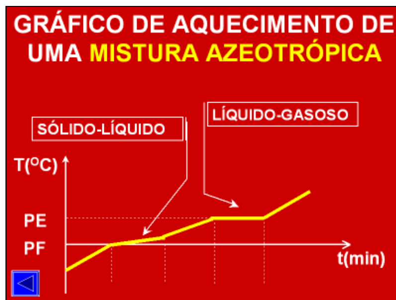
Fig. 7 – Gráfico de aquecimento de uma mistura azeotrópica
